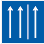
223.1-50 Seitenstreifen befahren, 2 Fahrstreifen plus Seitenstreifen
