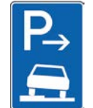
315-51 Parken auf Gehwegen halb in Fahrtrichtung links, Anfang
