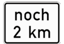
1001-33 noch ... km (gemäß VwV-StVO in Tunneln)
