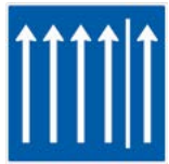
223.1-52 Seitenstreifen befahren, 4 Fahrstreifen plus Seitenstreifen
