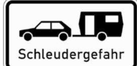
1006-30 Schleudergefahr für Wohn- wagengespanne an Gefällestrcken mit starkem Seitenwind auf Autobahnen
