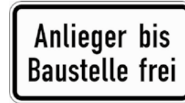
1028-32 Anlieger bis Baustelle frei
